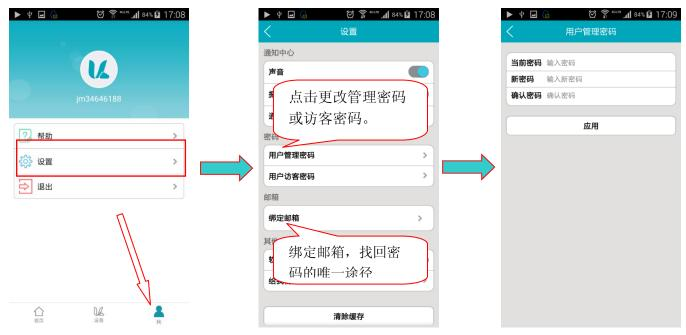
注: 1.通过管理密码登陆的用户可以添加或删除该账号中的摄像机,可以对摄像机的参数进行修改, 2.访客密码登录只能观看、旋转画面和语音对讲,不能修改该摄像机的其他参数。
