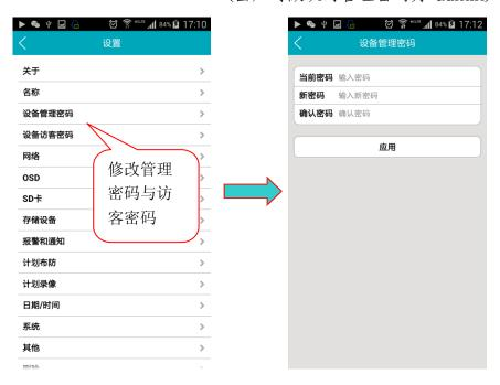
注意:设备密码与前面提到的账号密码是两个独立的密码,设备密码是储存在设备里,无法找回的,其作用如:多个账号都有添加此同一设备,一经修改,其他账号则失效无法观看。
