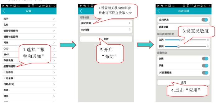
I/O 报警输入:选择常开时,对应报警输入口连接外部报警探头(如门磁,红外,烟感等报警探头)必需是常开型的报警探头。当有警情发生时,探头开关闭合,触发网络摄像机产生警情,并按照用户设置 的功能进行报警; I/O 报警输出:选择常开时,对应报警输出口连接外部的报警设备(如报警高音喇叭,声光报警设备等)必需是常开型,当有警情发生,用户设置了报警联动 I/O 口输出时,摄像机报警输出口开关闭合,触发 外部报警设备工作; 灵敏度:用于设置运动侦测的灵敏度,数值越大灵敏度越高,相对产生的误报警的机率就越大,一般用默认值即可,也可自行设置
